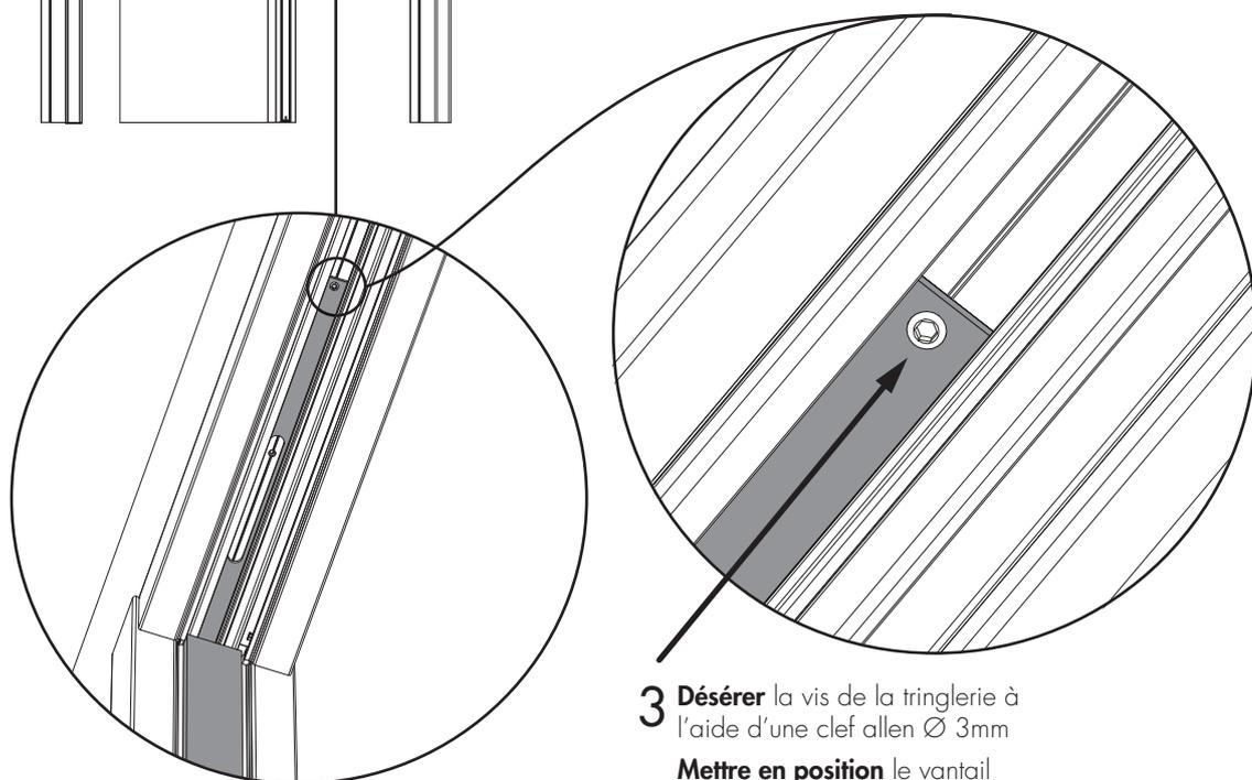
**3 Désérer** la vis de la tringlerie à l'aide d'une clef allen  $\varnothing$  3mm
