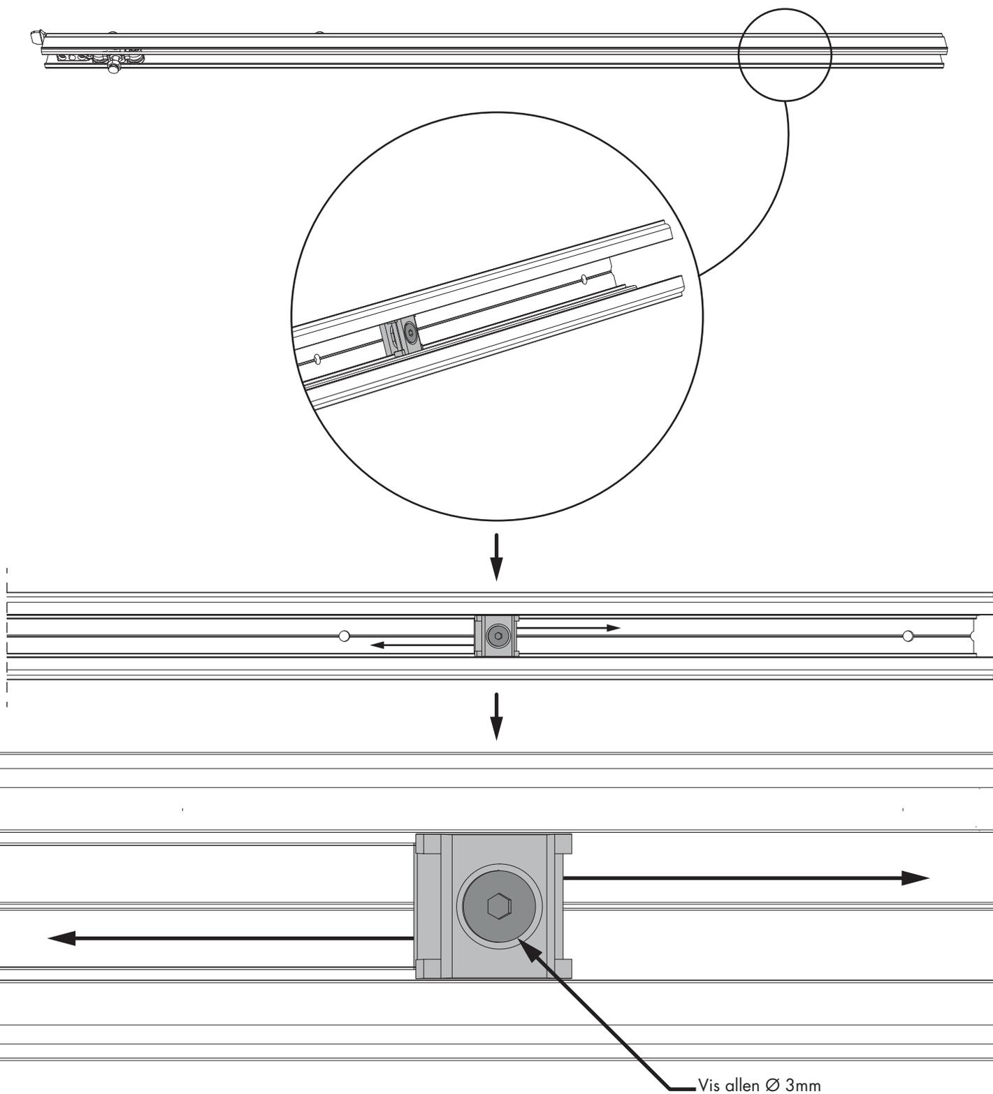
**1 - Déserrer** la vis à l'aide d'une clef allen Ø 3mm
